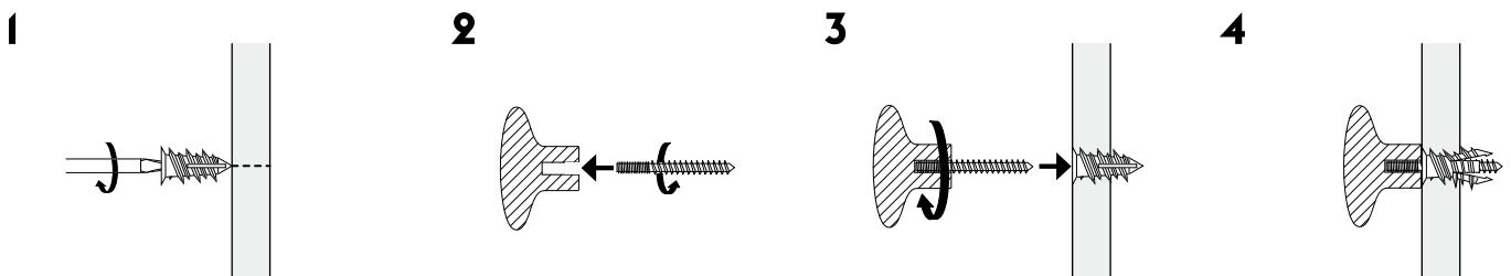
プラスドライバーでアンカーを直接壁面にねじ込みます。
